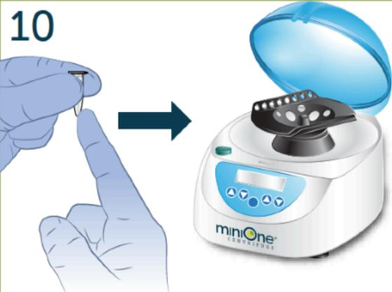
Recupera la tua provetta dalla macchina PCR e falla girare per 1 minuto ad almeno 8.000 RPM in una centrifuga da banco per raccogliere i detriti cellulari sul fondo della provetta.
