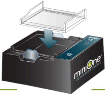
**13** Versare 135 mL di buffer di corsa TBE in un lato del serbatoio, permettendo al liquido di spingere fuori l'aria presente sotto al vassoio del gel, creando un fondo uniforme senza bolle d'aria intrappolate per l'imaging chiaro dei risultati.
