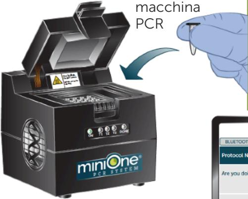
**9** Usa il tuo dispositivo mobile con l'App PCR mobile, programma la macchina PCR usando la modalità di temperatura costante per incubare i campioni a 95°C per 300 secondi (5 minuti) per rompere le cellule e rilasciare il DNA in soluzione. Inserire 4°C per la temperatura di incubazione finale. Ciò manterrà i campioni freddi fino a quando non sarete in grado di prelevarli.
