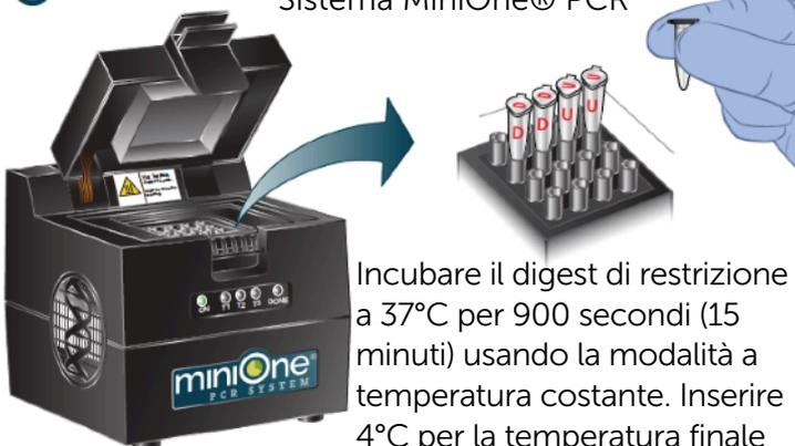
Incubare il digest di restrizione a 37°C per 900 secondi (15 minuti) usando la modalità a temperatura costante. Inserire 4°C per la temperatura finale di incubazione.
